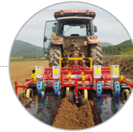
트랙터 직파 작업 트랙터 부착형 로터리에 비닐피복과 파종을 동시에하는 직파파종
